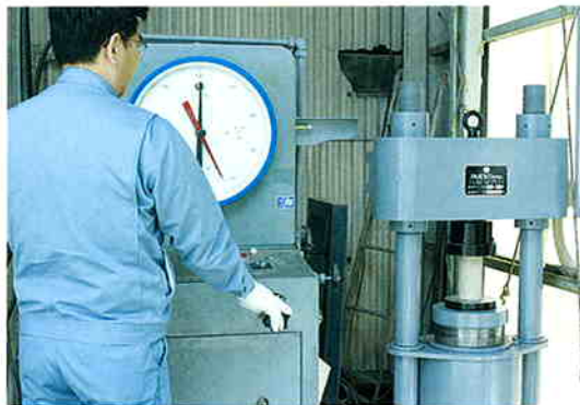
圧縮強度試験
